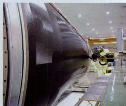
(b) 采用自动铺丝技术制造的 B787 后机身
